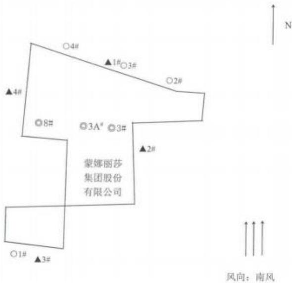
注：“◎”为固定源废气检测点，“○”为无组织废气检测点，“▲”为噪声检测点
